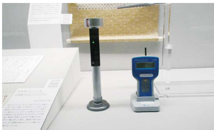
左がエアサンプラー（浮遊カビ調査）、右がパーティクルカウンター（塵埃調査）
